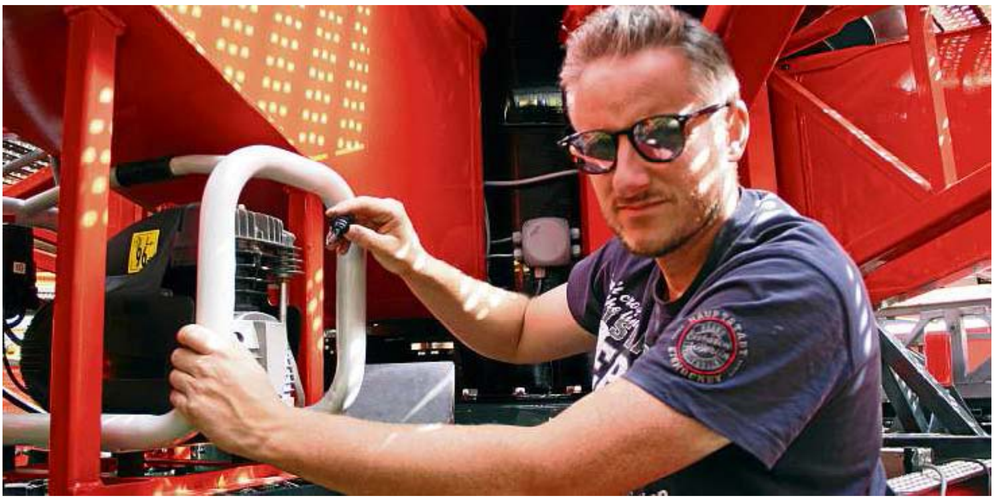
Inhaber Christoph Meyer überprüft eine der Bremsen am Fahrgeschäft „Break Dance“. Bevor sich die Wagen gewohnt rasant im Kreis und um die eigene Achse drehen, warten Meyer und ein Techniker die Maschine an jedem Morgen. Fotos (2): Norman Börner
